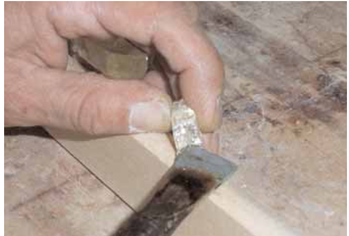
Figure 6.4.4 Ponçage de la gomme laque
