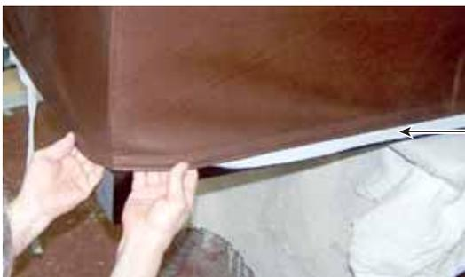
Bande de nylon protégeant le velcro et empêchant la housse de finition d'adhérer à la housse de nylon.
