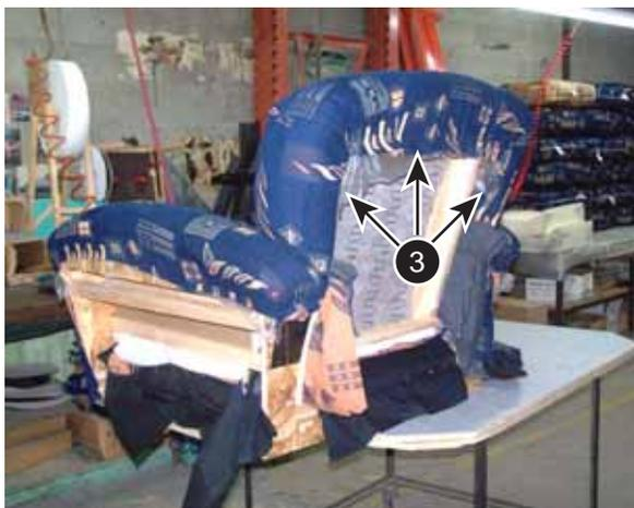
3. Couper l'excédent du matériau de revêtement etagrafer le matériau à l'arrière du dossier. L'agrafage sera camouflé, lors de la finition, par le matériau de revêtement installé à l'arrière du dossier.
