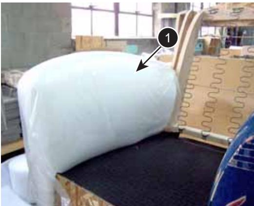
1. Placer une pellicule très lisse et mince sur la partie à recouvrir. Cette étape facultative facilite l'insertion et le positionnement du matériau de recouvrement sur la bourre de protection.
