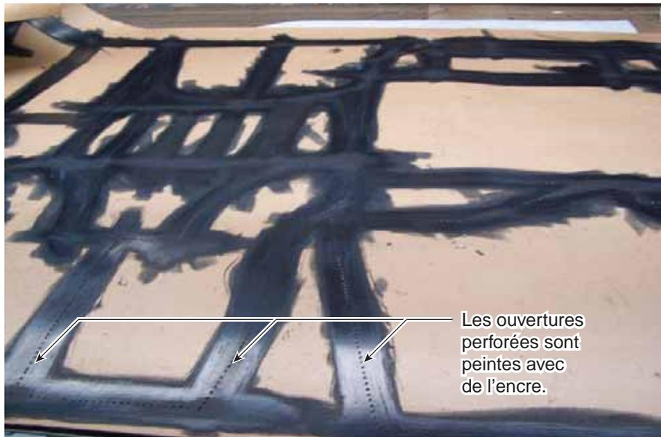
Un seul ou plusieurs patrons sont placés sur le matériau de recouvrement. On utilise parfois une craie de chaux ou de cire afin de tracer le contour de pièces à découper.
