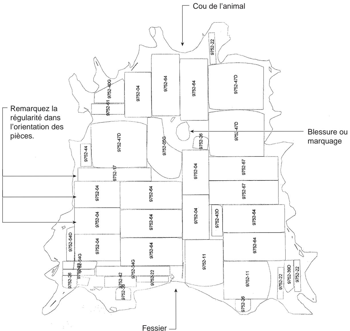
**Figure 1.2.3 Optimisation des plans de coupe – Matériau textile**
