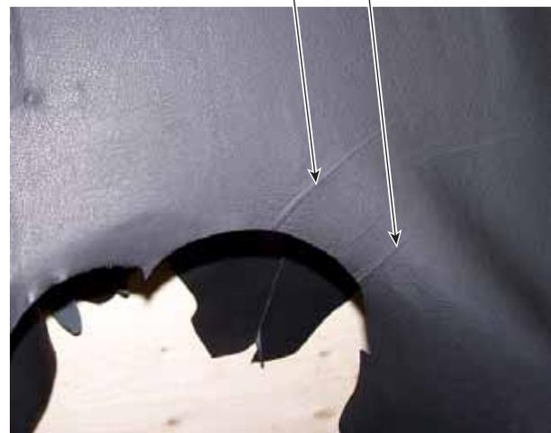
Le plan de coupe doit tenir compte de ces éléments afin que ces imperfections ne soient pas apparentes sur le meuble garni. Optimiser un plan de coupe signifie qu'il faut obtenir la meilleure qualité possible du matériau et prévoir une disposition logique et harmonieuse des pièces, qui seront taillées avec précision.
