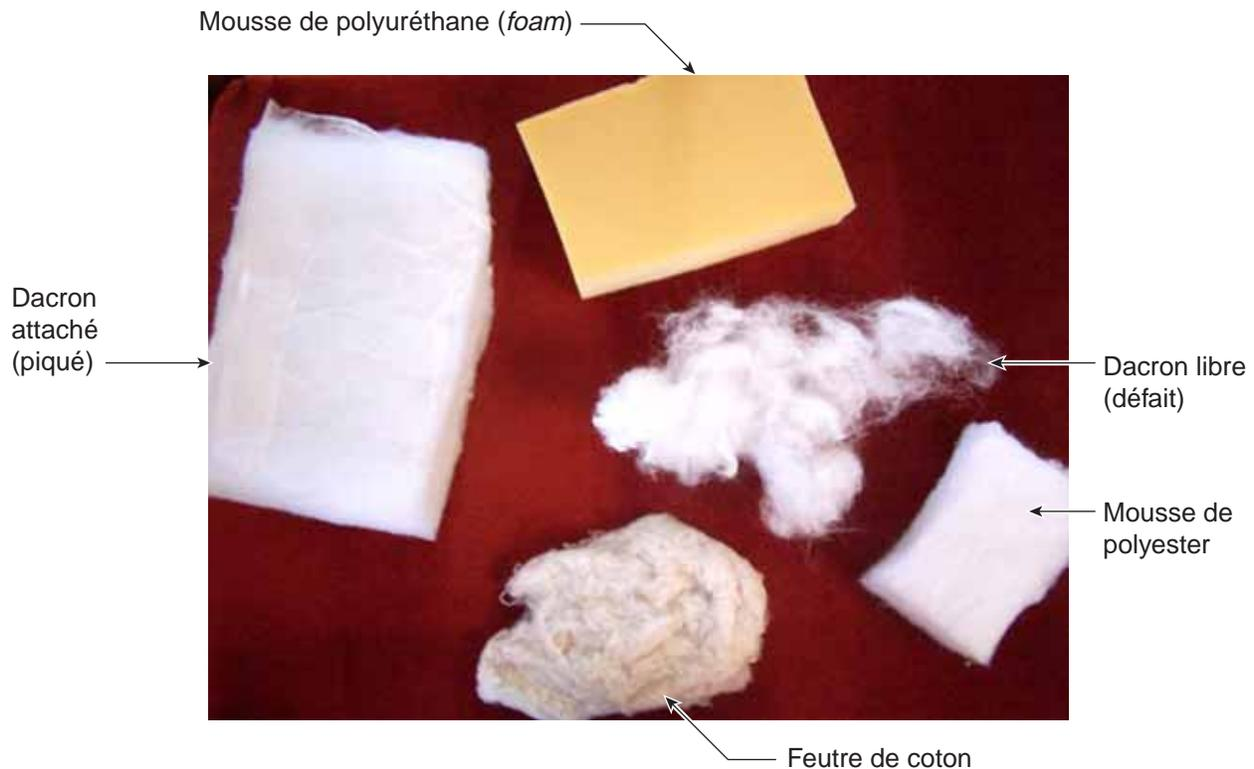
Lors du pré-garnissage du meuble (tâche généralement réalisée par le rembourreur), la bourre de protection est posée sur les sangles, les ressorts ou le bâti afin de rendre le meuble confortable. Elle est choisie en fonction de l'endroit où elle est posée et de la qualité du meuble recherchée. Ultérieurement, elle sera recouverte par le rembourreur.
