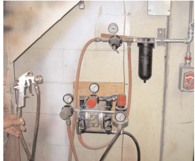
Figure 1.4.23 Système de vaporisation à membrane
