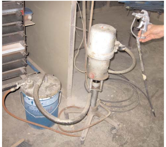
Figure 1.4.22 Système de vaporisation sans air
