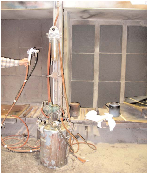
Figure 1.4.18 Système d'alimentation par pression
