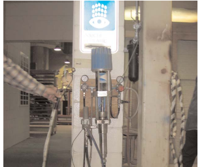
Figure 2.2.9 Système de vaporisation à air assisté
