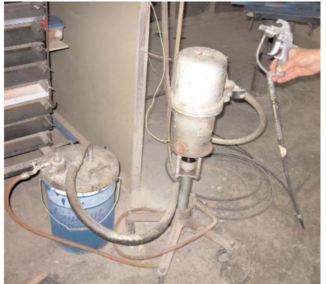
Figure 2.2.10 Système de vaporisation sans air
