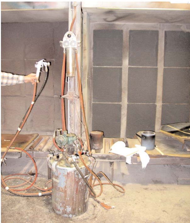
Figure 2.2.6 Système d'alimentation par pression
