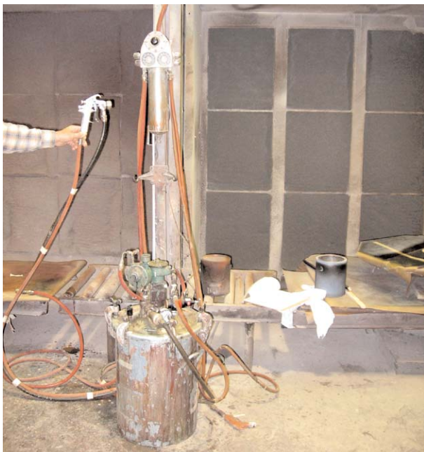
Figure 4.2.7 Système d'alimentation par pression
