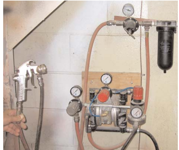
Figure 4.2.11 Système de vaporisation à membrane
