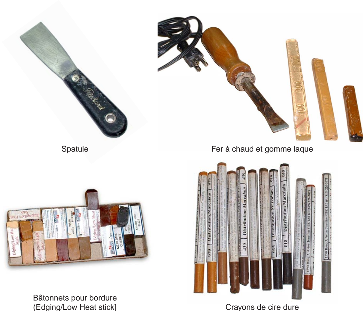
Figure 6.4.1 Produits et outils de retouche et de réparation
