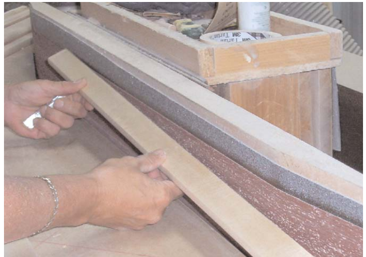
Figure 6.4.4 Ponçage de la gomme laque
