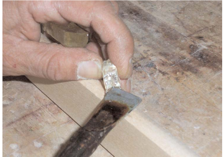
Figure 6.4.4 Ponçage de la gomme laque
